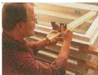
型みの検査。 精細に作られた窓が生産されています。
